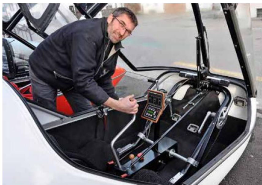
Blick in die Twike-Kabine: Joystick, Bordcomputer und zwei Paar Pedale.
